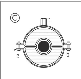
Beide Schrauben (2,3) gleichmäßig anziehen, damit die Verbindungs-
