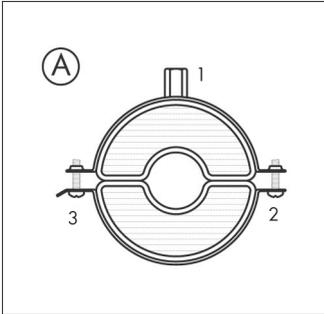
flexen® Kälterohrschelle K in geschlossenem Zustand, mittels Kombi-
